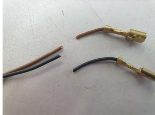
**6. Führen Sie die Kabelenden des neuen Schalters in den Sockel ein. Tipp: Biegen Sie die Enden etwas rund und führen Sie die Kabelenden mit der Biegung nach unten zeigend ein, um das Einführen zu erleichtern.**
