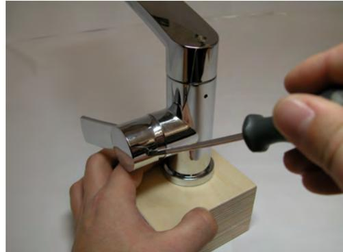
**Oder: Wenn keine Arretierung vorhanden ist, drehen Sie den Bedienhebel aus dem Gehäuse und ziehen Sie dieses dann einfach ab.**
